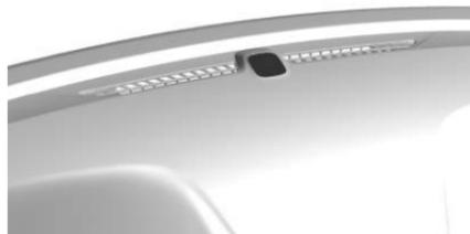
Hay un sensor de luz en la parte superior del tablero de instrumentos. No cubra el sensor, de otra manera los faros se encenderán cuando no sea necesario.
