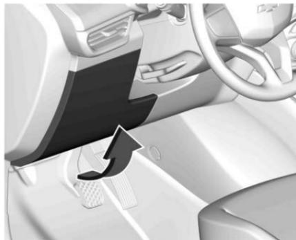
El bloque de fusibles del tablero de instrumentos se encuentra en el lado inferior del tablero de instrumentos del lado del conductor.
