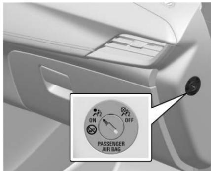
La bolsa de aire del pasajero delantero se puede desactivar mediante un interruptor operado con llave en el lado del pasajero del tablero de instrumentos.
