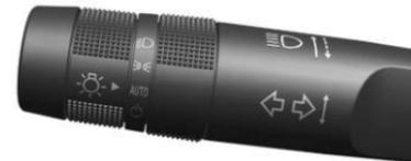
☰● : Con los faros encendidos, presione la palanca de señal direccional hacia adelante y libérela para encender las luces altas. Para volver a las luces bajas, empuje la palanca de nuevo o jálela hacia usted y libérela.
