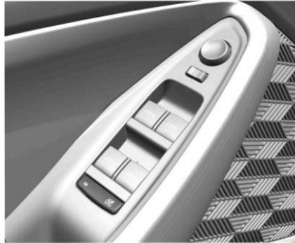
Presione el interruptor
