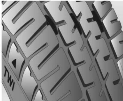
Las llantas también deben reemplazarse cuando la profundidad de la banda de rodadura se haya desgastado cerca del TWI. La imagen muestra dónde se puede encontrar la profundidad de la banda de rodadura.
