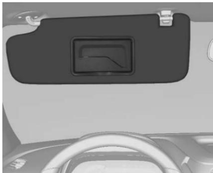
Los parasoles se pueden plegar hacia abajo o girarse a un lado para evitar deslumbramiento.
