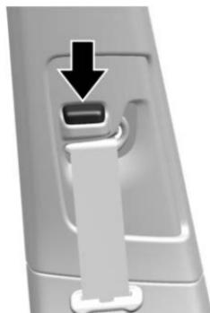
Oprima el botón de liberación y mueva el regulador de altura a la posición deseada. El regulador puede moverse hacia arriba empujando el deslizador/compensador hacia arriba. Después de que el ajustador se coloque en la posición deseada, intente moverlo hacia abajo sin presionar el botón de liberación, para confirmar que se haya asegurado en su posición.
