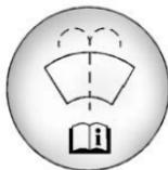
Abra el tapón que tiene el símbolo del lavaparabrisas. Agregue líquido para lavaparabrisas hasta llenar el tanque. Vea en *Vista general del compartimiento del motor* ⇨ 121 la ubicación del depósito.
