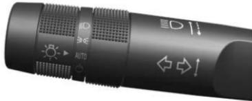
Mueva la palanca completamente hacia arriba o hacia abajo para señalar una vuelta.
