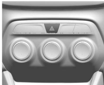
⚠ : Oprima para hacer que las luces direccionales delanteras y traseras destellen intermitentemente. Presione ⚠ nuevamente para apagar los intermitentes.
