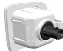
2. En la parte posterior de la defensa, gire el soporte del foco en sentido contrario al de las manecillas del reloj para desenganchar.
