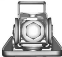
9. Coloque la cabeza de elevación del gato en el punto para colocación del gato que esté más cerca de la llanta pinchada. Ese punto está indicado por una ranura en el borde inferior vertical del lado de la
